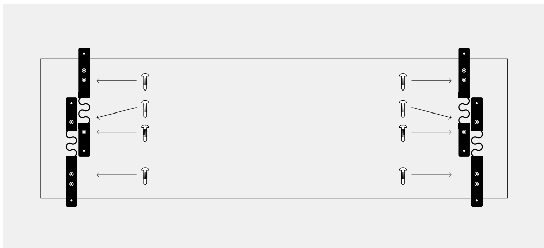
Figure 16 : Attacher des PT Mini aux lames de terrasse Alpin
