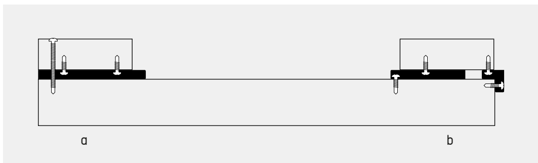
Figure 25 : Fixation de la première/dernière lame avec PT Mini
