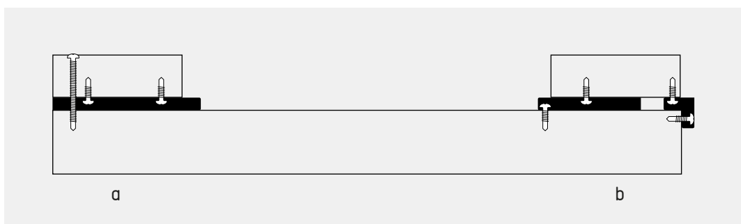
Abbildung 25: Befestigen der ersten/letzten Diele mit TG Mini
