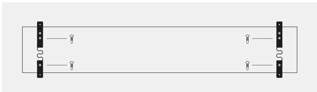
Abbildung 22: Anbringen von TG Mini auf Kollin-Diele
