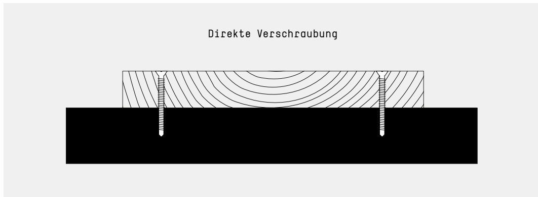
Abbildung 10: Verschraubungs-Schema direkte Verschraubung
